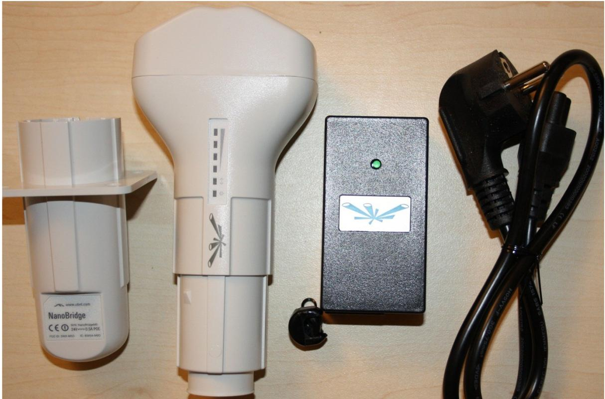
**1 .** Подключаем **NanoBridge** к устройству PoE (порт Power Over Ethernet), порт LAN подключаем к локальной сети либо непосредственно к компьютеру.! Внимание! Сначала подключите все провода к устройствам (порт PoE, порт LAN к локальной сети либо непосредственно к компьютеру только после этого подключит адаптор PoE к электрической сети
